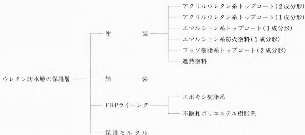
耐久性を持っているが、直射日光・オゾン・酸性雨などの影響により、表面は徐々に劣化して行く。この防水層表面の劣化を、保護層で防いでやる事により、長期に涉って防水性能を保持させる事が出来る。
