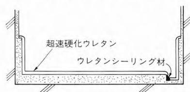
図-2 階段床防水断面図(在来工法)
