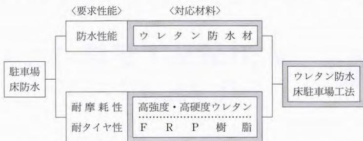
図1 駐車場床防水の要求性能とウレタン防水システム
