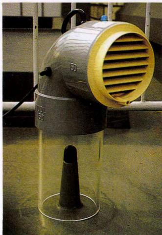
「サンシラール・ファン」は，改修工事の施工過程において従来の脱気筒，あるいは新たに設置した脱気筒の上に覆い被せて作動させることにより，強制的に空気の流れを発生させ，下地の乾燥を効果的に行うものです。
