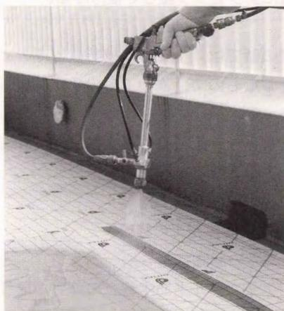
写真 ノズル内混合・2ホース-エアレススプレー装置
