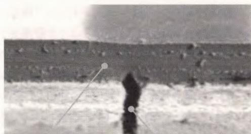
防水層断面 下地ひび割れ部
