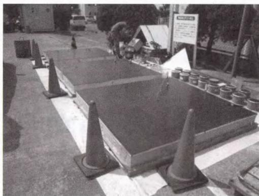
写真1 ふくれ圧力の測定状況
