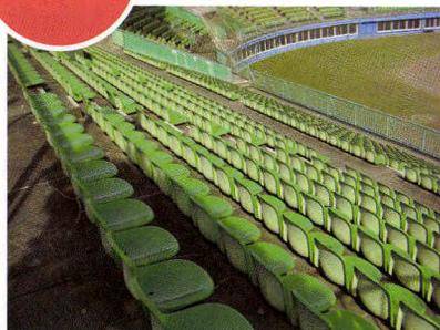
○観覧席独特の階段状のため、出隅、入隅及び立上り部が多く、また工期も短縮できることから超速硬化ウレタン吹付け工法と保護仕上塗料に高耐候性のフッ素塗料をご提案してご採用いただきました。
