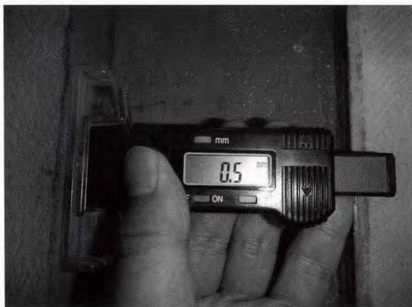
写真8 膜厚計による測定
