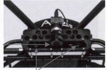
前方2眼ステレオカメラ (水平方向の距離制御)
