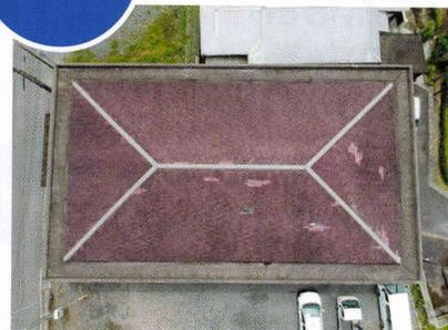
○既存屋根材のコロニアルが台風の被害で、一部ハガレ・漏水が発生コロニアルを全面撤去し、コンクリート面を露出させた後超速硬化ウレタン塗膜防水材料が採用されました。
