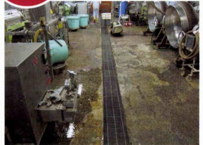
○耐衝撃性・耐温水性が求められ、かつ食品を取り扱う工場であったため、環境対応型の硬質ウレタンでの床面工法が採用されました。
