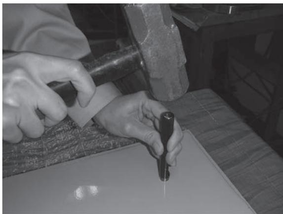
写真17 ポンチによる試験片の採取
