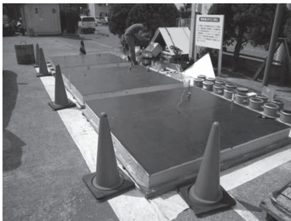
写真12 膨れ内圧力測定試験の状況
