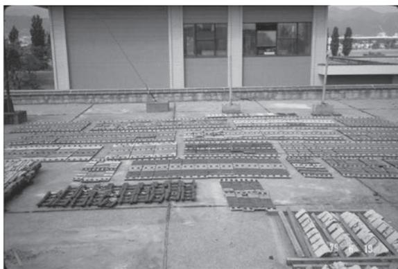
写真2 合成高分子防水材料と防水層の屋外暴露試験
