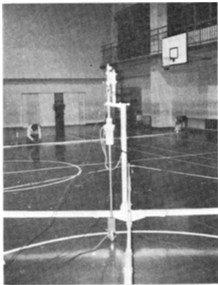
体育館床の弾力性測定装置 (東工大 小野研究室提供)
