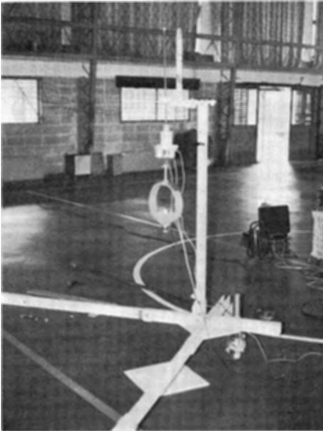
転倒衝突時の床のかたさ測定装置 (東工大 小野研究室提供)
