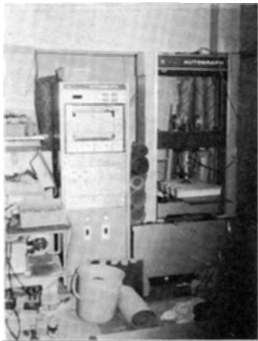
歩行時の床のかたさ試験装置 (東工大 小野研究室提供)
